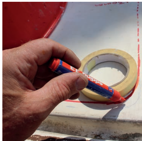
8 Tegn med tusch om en passende runding f.eks. tape-rullen eller et drikkeglas. Lav rundingerne store.
