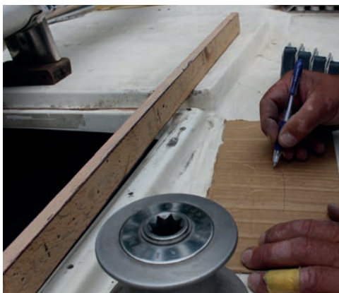
7 Lav skabelon i karton for alle rundinger. De lige linjer tegnes parallelt med recessen direkte på gelcoaten og i samme bredde som nedgangen under skydekappen.
