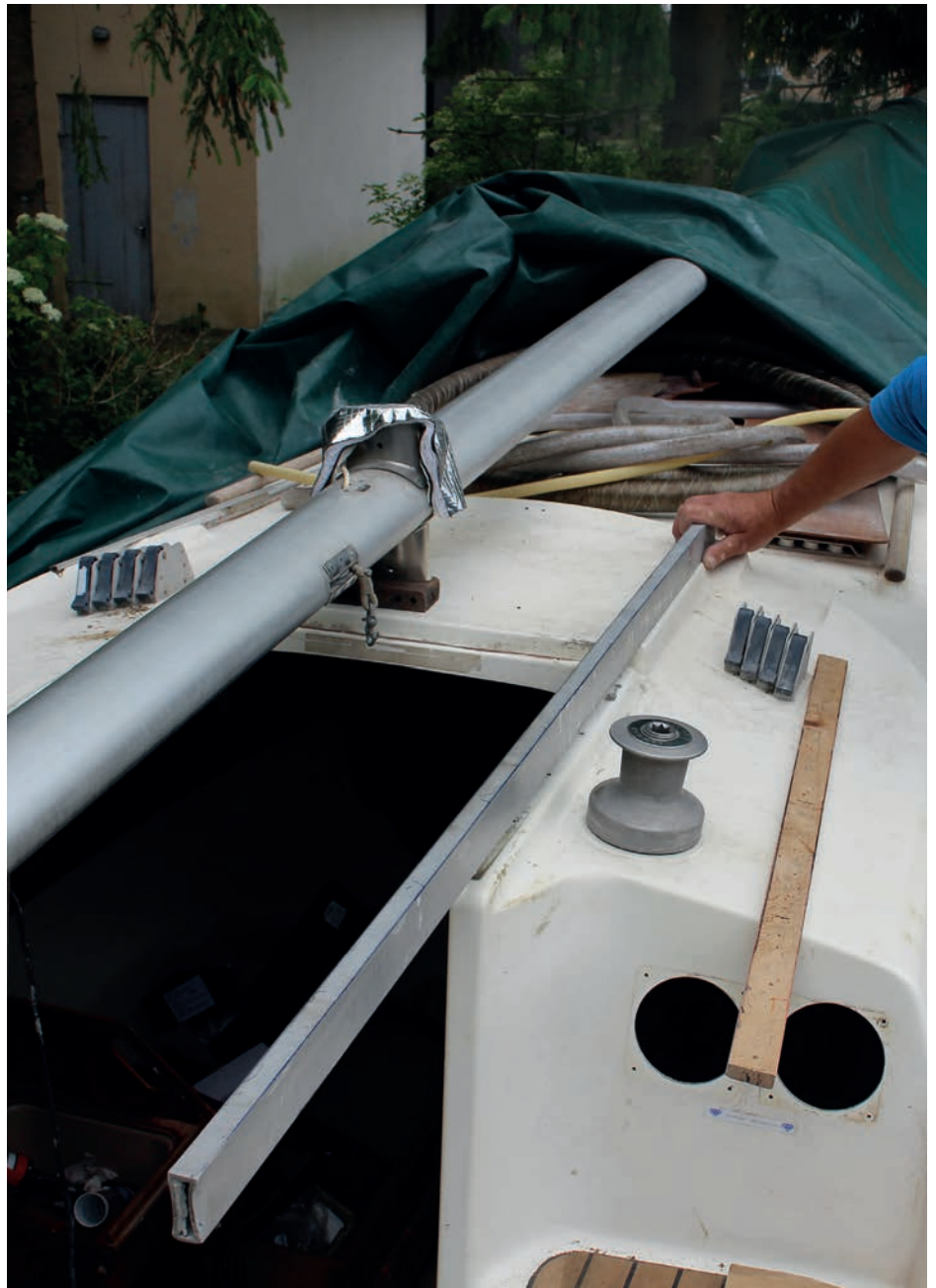
6 Brug retskeden til at kontrollere at anlæggets niveau passer i hele længderetningen.
