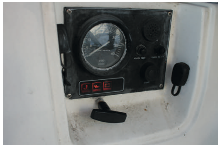
6 Start motoren og se at ladelampen slukker.
