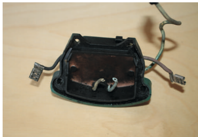
4 Skru de to skruer der holder spændingsregulatoren ud og løft det elektriske kredsløb. Regulatoren vil dog stadig hænge fast med to ledningerne til slæbekullene.
