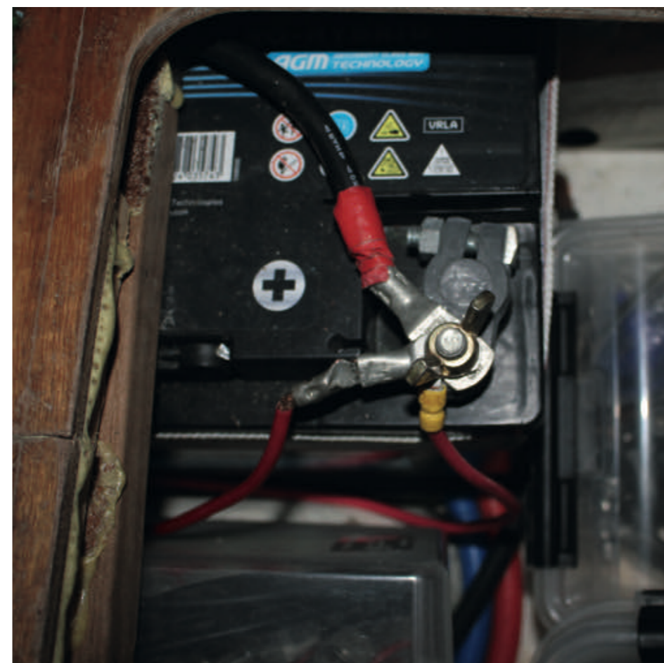
1 Demonter ledningerne fra batteriet for at undgå kortslutning.
