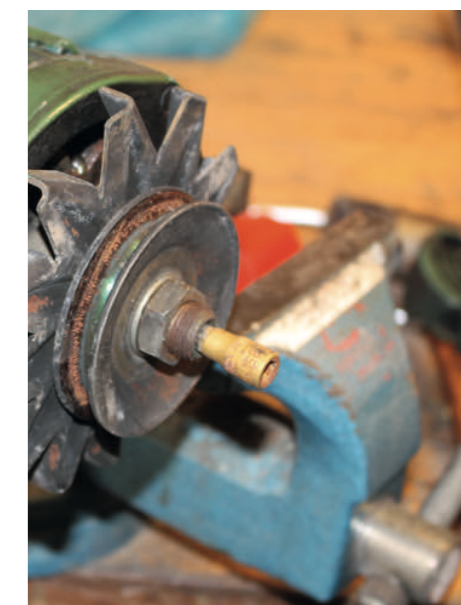
5 Træk generatorboltten ud og sæt generatoren i en skruestik.
