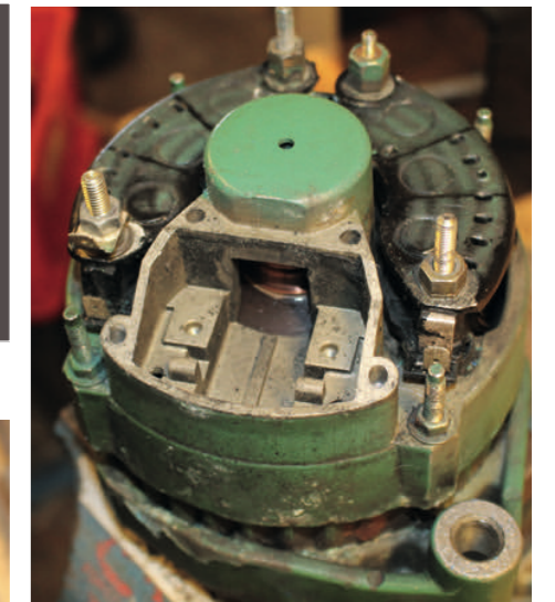
2 Med en diodebro ensretter generatoren vekselstrømsspændingen til jævnstrømsspænding som dermed kan lade på båd-batteriet. Når man skal måle på diodebroen, så skal der anvendes et multimeter med diodemålingsfunktion.
