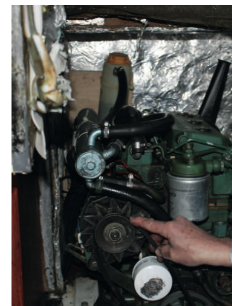
4 Vip generatoren frem, så kileremmen bliver løs. Tag kileremmen af remskiven.
