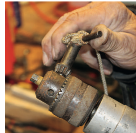
2 Sæt en 8 mm unbrakospids fra et skruetrækkersæt i borepatronen på en boremaskine. Anvend alternativt en oversavet 8 mm unbrakonøgle.
