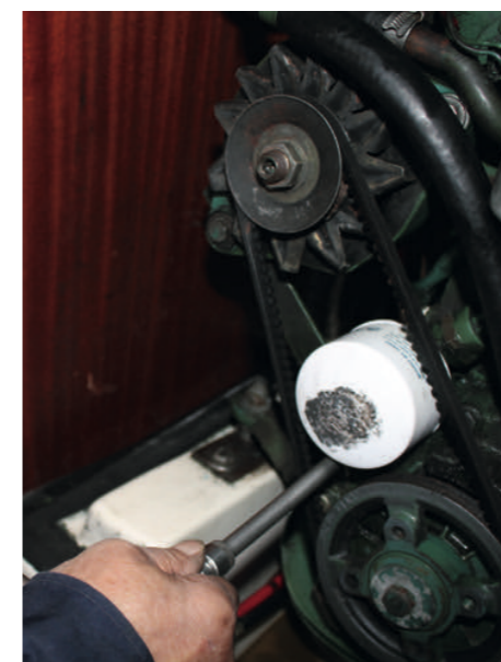
3 Spænd generatorens kilerem op ved at løsne generatorboltten på motoren og tilspændingsboltten.
