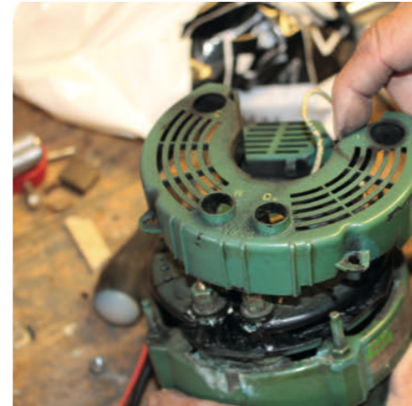
2 Fjern de møtrikker som holder plastikskjoldet på W og D+.
