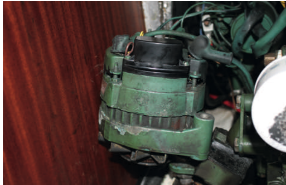
1 Monter ladeledningerne fra batteri og motor på generatoren inden generatoren monteres på motoren i båden.
