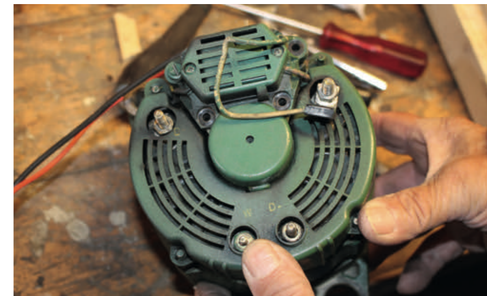
3 En vekselstrømsgenerator er en meget effektiv batterilader i forhold til en jævnstrømsdynamo.
