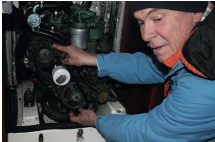
3 Sæt kileremmen på henholdsvis generator og motordrevskive.
