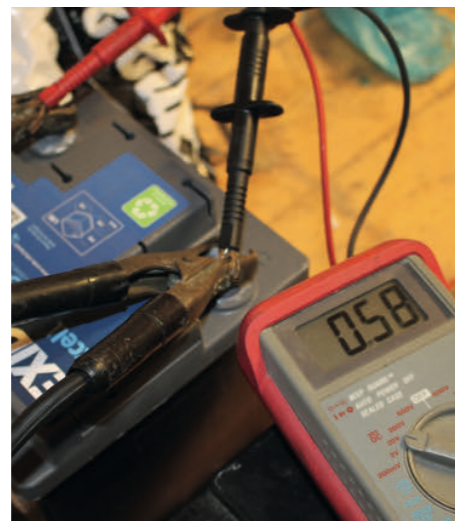
5 Sæt et multimeter på volt og sæt målesonderne på henholdsvis plus og minus på batteriet.
