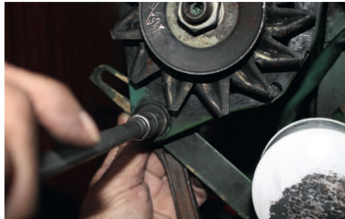
4 Spænd tilspændingsbolt. Husk bøsningen og de to gummiskiver.
