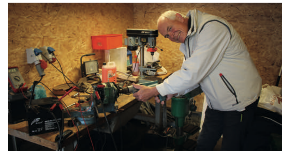
5 Test generatoren med boremaskinen igen. Afhængig af hvor meget batteriet er afladet, vil generatoren lade med op til seks ampere, og regulatoren vil justere så spændingen på batteriet vil være ca. 14 volt.
