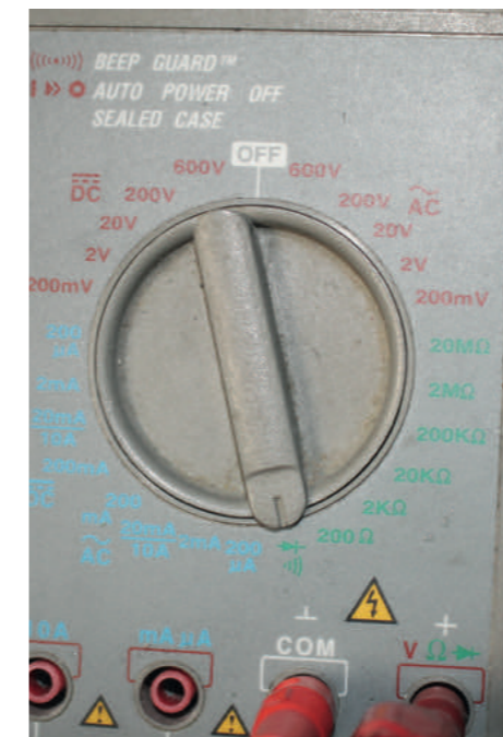
4 Mål diodebroen med multimeteret sat på diodemåling. Sæt den ene målesonde til B + polen og den anden til D - polen. Generatoren skal ikke rotere. Noter udslaget.
