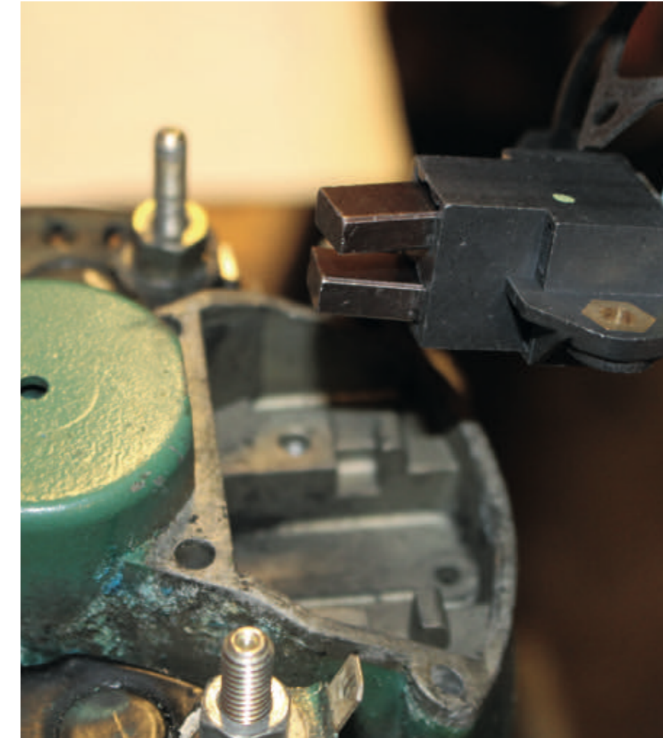
1 Vend den nye regulator så kullene let kan glides ind på generatorens kobber slæberinge. Skru regulatoren fast med de gamle bolte.
