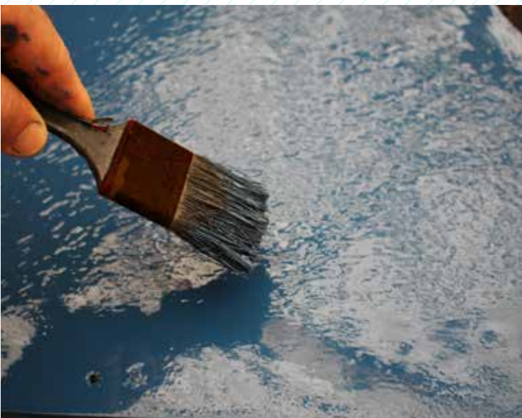
21 Mal evt. inderlaminatet med Brilliant Gloss i samme farve som ankerbrønden indvendigt.
