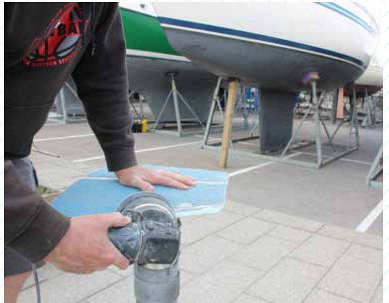
20 Slib fugekanten så den er flush med laminatsskallerne og passer i ankerbrøndshullet. Slib lugen de steder hvor dens anlægsliste er i brønden, hvis lugen er 2 mm for tyk i forhold til dækkets tykkelse.
