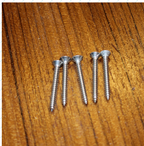
24 Sæt 3 mm skruer i de forborede huller og træk kantlisten tæt til plywooden med skruetrækker.
