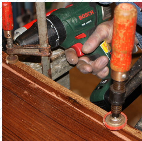
23 Forøg limtrykket med skruetvinger og sørg for at kantlistens øverste del er flush med fineroverkanten.
