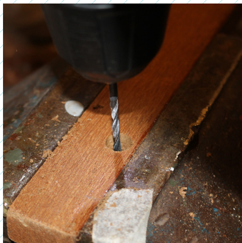
21 Bor skruehullerne for med et 3 mm træbor helt igennem kantlisten.
