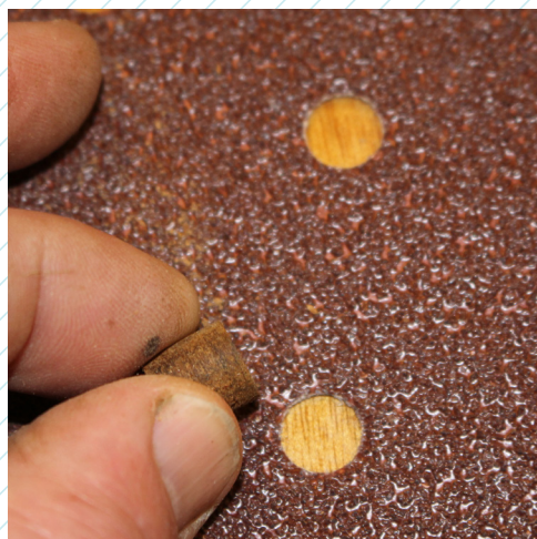
25 Slib teaktræspropperne så de bliver lidt koniske. Derved centrerer de bedre i prophullerne.
