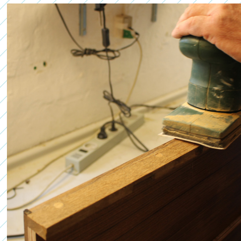
29 Sluttelig slibes den nye kantliste med rystepudser eller excenterpudser. Sørg også for at alle skarpe trækanten er brækket af i en pæn runding. Det gør at kanten står pæn og afbræk af splinter undgås, når cockpittet benyttes.
