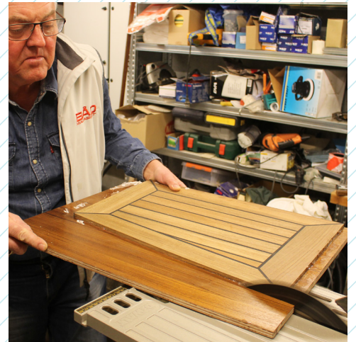
19 Skær overskydende plywoodplade af på de respektive sider med fuksvans eller rundsav.
