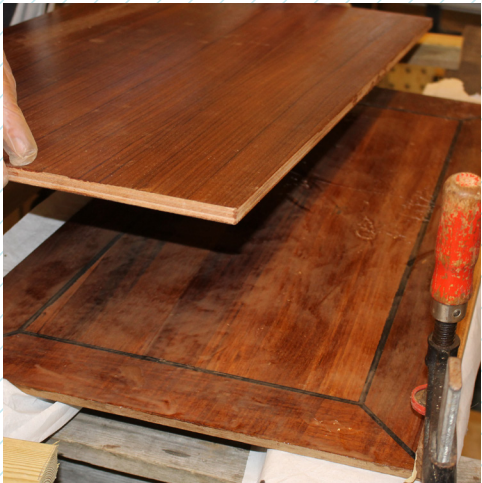
17 Læg plywood-pladen ned i limoverfladen og hold limtryk med skruetvinger i et døgn tid.
