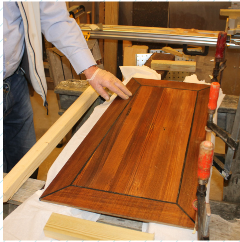
15 Afdæk kantlisten på den del som ikke skal have lim med maletape. Hold kantlisten med skruetvinger.
