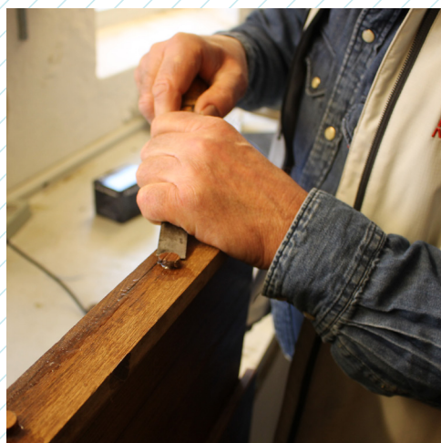
27 Slå toppen af proppen af med et skarpt stemmejern. Husk at vende pennen omvendt og slå i åreretningen.
