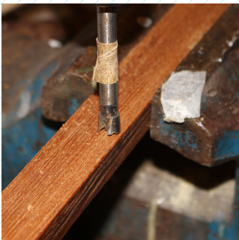
20 Tilpas kantlisterne på længde og bredde. Brug evt. målet fra den gamle lugekant. Mærk hvor de rustfrie skruer skal sidde. Skrueerne fordeler limtrykket jævnt mellem finerkanten og kantlisten. Bor prophullerne med et 10 mm kunstbor ca. 5 mm ned i kantlisten.
