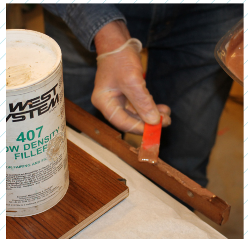
22 Fordel den fortykkede lim på kantlisten med spartel.
