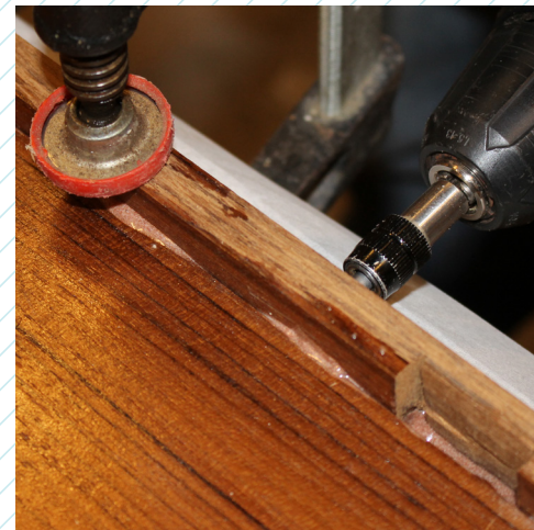
24 Sæt 3 mm skruer i de forborede huller og træk kantlisten tæt til plywooden med skruetrækker.
