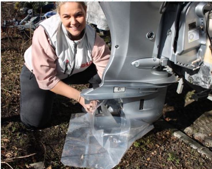
1 Fold den kraftige pose ud og træk den op om motorbenet samt propellen.
