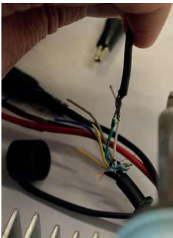
11 Lod VHF-radioens grønne ledning med en ekstra ledning så den kan nå at sættes sammen med de andre ledninger til bådens 12 volt minusledning. Husk at isolere lodningen med krympeflex eller isoleringstape.
