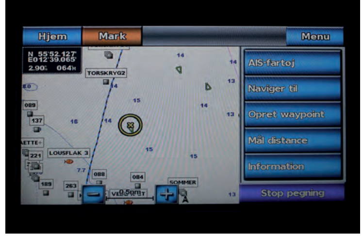
12 Tænd plotteren og sæt SD-kortet i kortlæseren. Tryk menupunktet "Navigationskort" og bådens position vil være markeret.
