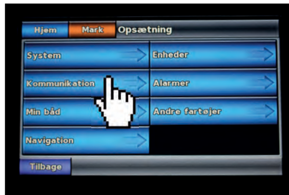
13 For at få søkortplotterens GPS-kordinater på VHF-radioen og dermed kunne anvende distress-systemet ved ulykker: Tryk "Opsætning" efterfulgt af "Kommunikation".
