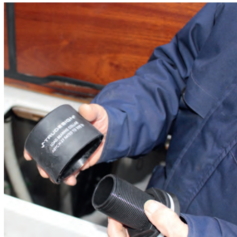
21 Støttemanchetten passer til gennemføringen og søventilen. Den fordeler belastningen i gennemføringen på et større område. Påfør fugelim inden gennemføringen sættes i hullet.
