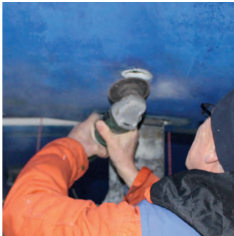
20 Slib med skrubskeive en reces på ca. 30 grader. Unøjagtigheder jævnes, når gennemføringen sættes i med fugelim i hullet.
