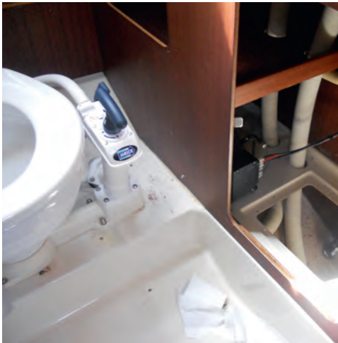
10 Afrund slangehullets kanter med korn 80 sandpapir. Der må ikke være skarpe kanter, som kan skamfile gummislangerne, så de bliver utætte.
