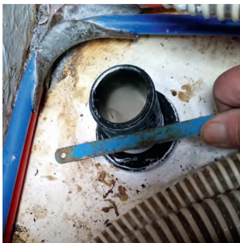
23 Skær med klinge ca. 15 mm af toppen på gennemføringen for at støttemanchetten på skroget kan få tilstrækkelig plads for tilspænding med søventil.
