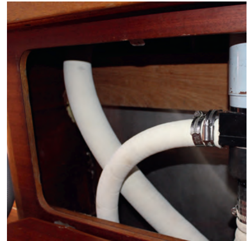
12 Monter altid kraftige dobbelte slangebindere på maceratorpumpe, holdingtank, søventil og toiletlet. I tilfælde af blokering må slangerne ikke falde af på grund af vandtrykket.
