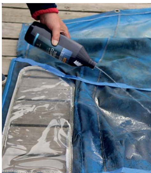
5 Textile cleaner havde ringe effekt fortyndet og blev derfor påført direkte fra beholder i ufortyndet tilstand. Samtidig blev testfeltet børstet skånsomt.
