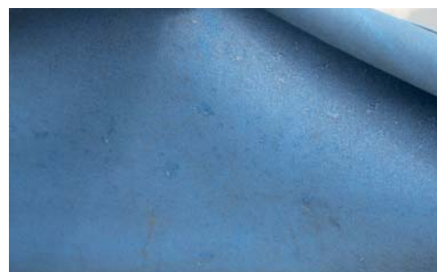
7 Textile protect støver overfladen og imprægnerer pletvis hvor sprøjtetågen rammer. Holder kun tæthed hvor produktet har gennemtrukket bompreseringsdugen.
