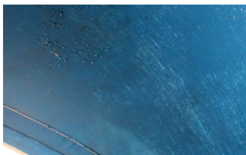
6 Simp 3003 og Simp 3003 Spray imprægnerer overfladen. Efter en sæsons eksponering er dugen ikke helt dråbetæt. Produktet skal påføres gentagne gange for at opnå fuld effekt.
