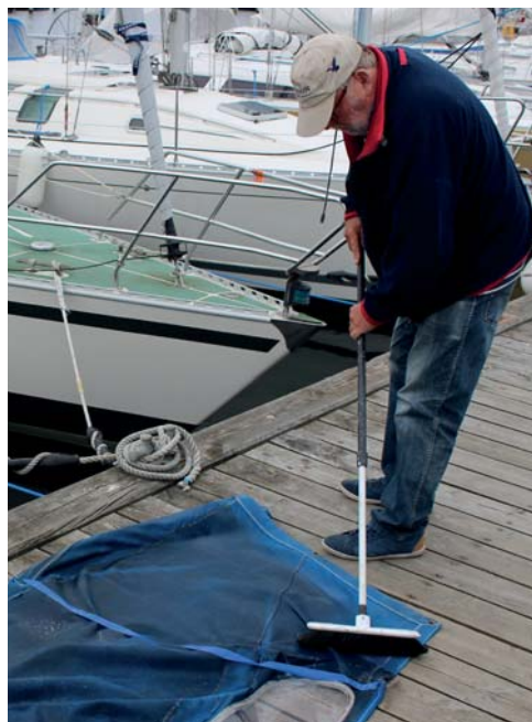
9 Ved at børste med en blød kost blev rensediljerne aktiveret, så effekten blev væsentlig bedre.
