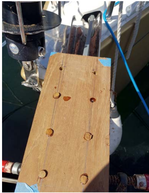
14 Spids propperne med sandpapir og dyp dem i lidt epoxylim. Placer propperne med træårene i samme retning som trinbrættets.
