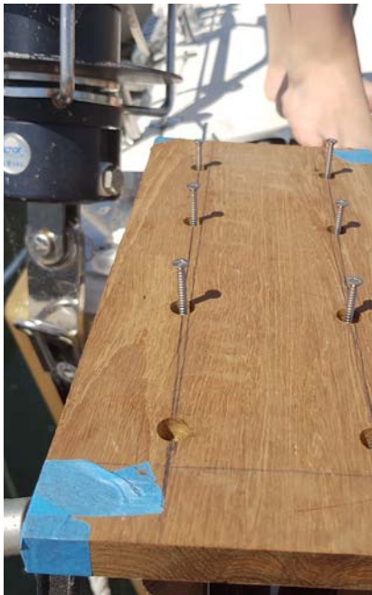
13 Sæt de 3 mm skruer med G/flex limen, som skal anvendes til teakræpropperne.
