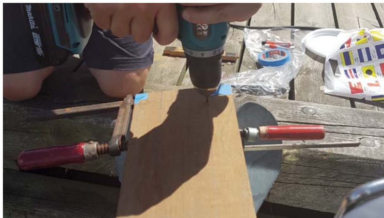
10 Bor for med 2 mm bor. Sørg for at bore tilstrækkeligt dybt.
