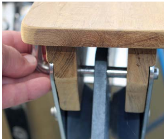
17 Fjern skruetvinger og bor hullet til ankerstoppet fra styrbord side.
