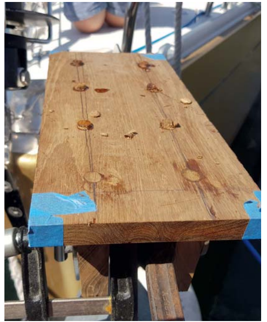
15 Slå propperne forsigtigt i med en hammer og stik derefter toppen af med stemmejern.
