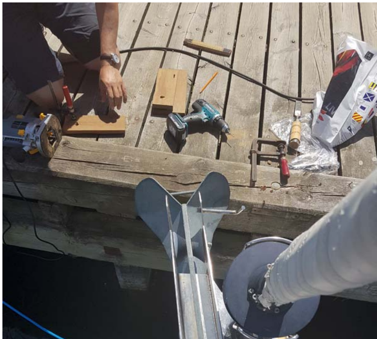
3 Brug havnemolen som høvlebænk. Sæt et par små skruetvinger ned mellem molelægterne og spænd godt fast.
