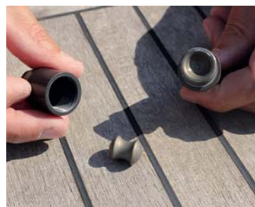
2 Tjek at den ny alu.-terminal passer til indfæstningen i masten og skil den ad.
