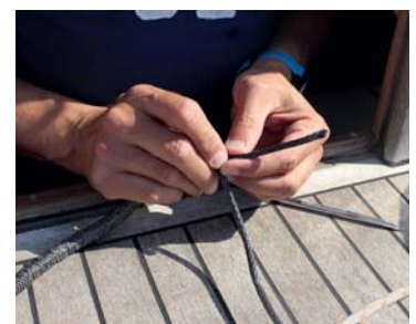
12 Udtynd linen ved at klippe fire kore af. Splejsningen tilspidses og afsluttes pænt.
