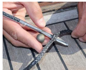
6 Mål tre nålelængder op på linen og stik nålen med line gennem fletværket.
