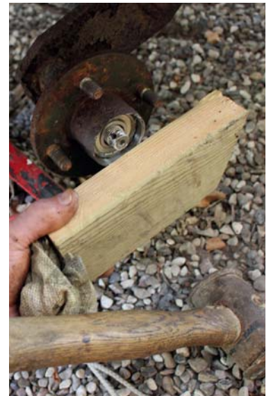
21 Placer navet på akslen og slå let med hammer på et mellemlæg af træ.
