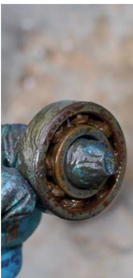
13 Lejet tages ud. Hvis det ruller ujævnt skal det skiftes for at navet ikke skal bryde sammen.
