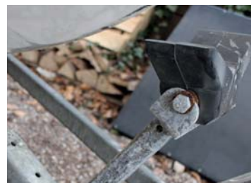
34 Indstil frontstøtten til stævncurven. Båden skal være spændt hårdt mod stævnanlægget så den ikke svajer ud fra traileren under en hård opbremsning.
