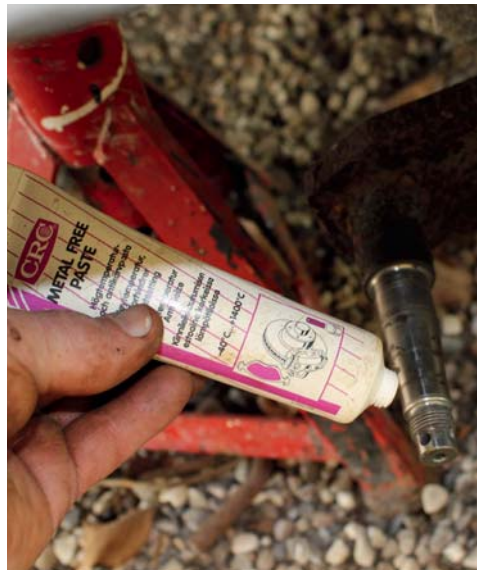
20 Fjern grater med smergellærrød på den koniske aksel og smør med metalfri maskinfedt.
