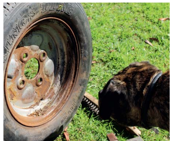
24 Sørg for at fælgene er i god stand. Fjern alt løstsiddende maling med skraber og slib rust med stålborste eventuelt monteret på en boremaskine. Det er ikke nødvendigt at tage dækket af.
