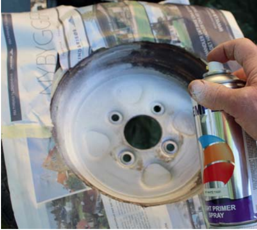
27 Grund fælgen med epoxy primer spray og lad den hærde i 8 timer. Mal med grå spraymaling efterfølgende.
