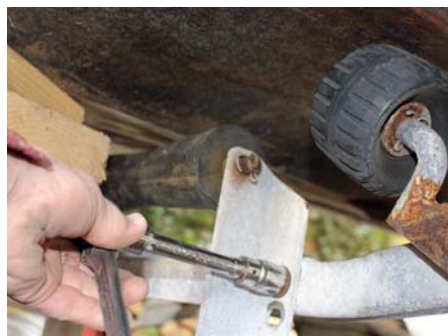
33 Sørg for at støtten hovedsagelig ligger på bådens kølbjælke. Indstil sidestøtter med topnøgle og husk at smøre boltene med korrosionshindrende fedt.
