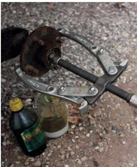
10 Placer en aftrækker med spindelen centreret i akslen og med griebakkerne om hjulnavet. Drej med krydsnøgle eller passende nøgle til navet glider af.
