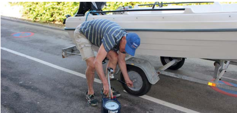
36 Tjek at lufttrykket er korrekt, jfr. trailermanual. Normalt skal trykket være 2,4 bar, som er det samme som de fleste biler. Det er vigtigt ved længere kørsel, at lufttrykket tjekkes, og hjulboltene efterspændes.
