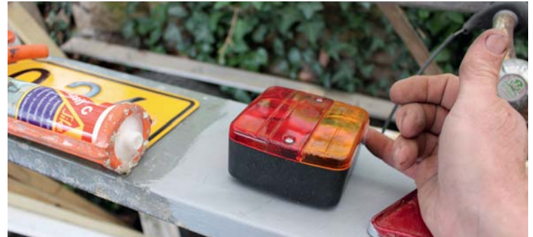
31 Seal trailerlygterne med silikon. Det forhindrer at fugt kan trænge ind og korrodere kontakterne.
