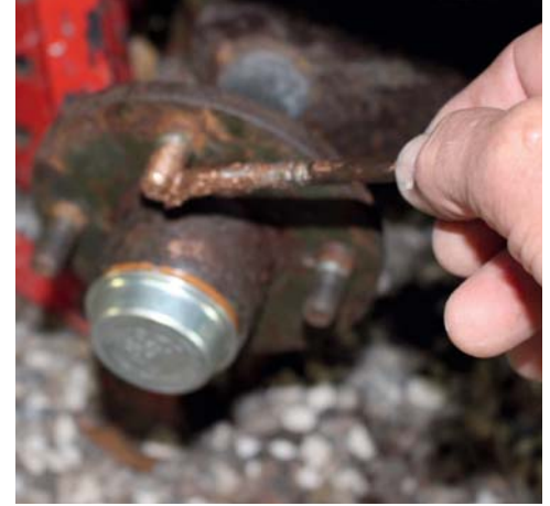
29 Smør hjulboltene med kobberfedt, det gør at hjulet er let at demontere. Sæt hjulene på akslen og spænd møtrikkerne på hjulboltene.
