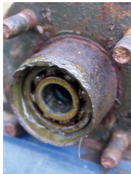
11 Placer navet i en skruestik og spænd det godt fast inden det yderste leje kan slås ud af navet.
