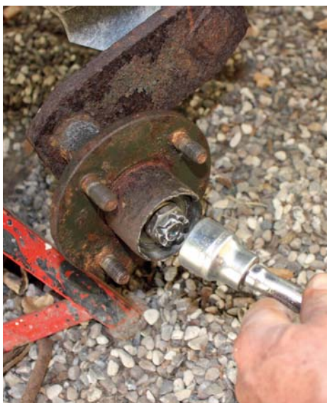
22 Sæt skive og kronmøtrik på akslen og spænd navet ind. Drej en halv omdrejning retur og sæt split gennem møtrik og aksel.
