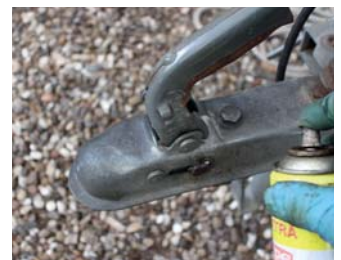
35 Smør alle bevægelige dele ved tilkoblingshåndtaget og trækket. Er trækkrøgen af den aftagelige type, skal alt rust fjernes og anordningen smøres ind i maskinfedt før krøgen monteres.
