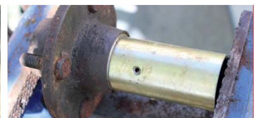
18 Sæt navet med leje i skruestikken og placer et passende rør eller trærundstok. Spænd kæberne let og kontroller at lejet presses jævnt i. Dette gøres på inderleje og yderleje.
