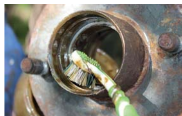
15 Rengør navet med petroleum og fjern rust med ståluld eller smergellæred. Fjern grater med fil eller smergellæred.
