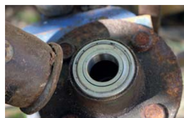
17 Læg navet på et plant sted, smør med fedt og læg lejet ned i lejeskålen. Slå det let med hammer eller klods så det centrere.
