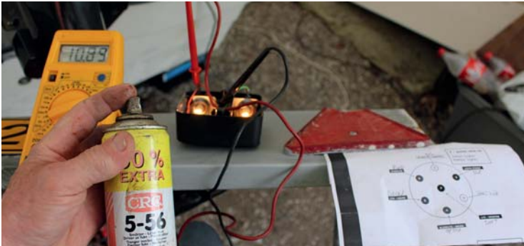
30 Sæt trailer lysstikket i bilen og tjek at alle pærer virker med et voltmeter. Spændingstabt vil normalt være et par volt afhængig hvor god el-forbindelsen er i stikkene. Anskaf et diagram over trailerstikket. Der findes 7-polet stik eller 13-polet stik.
