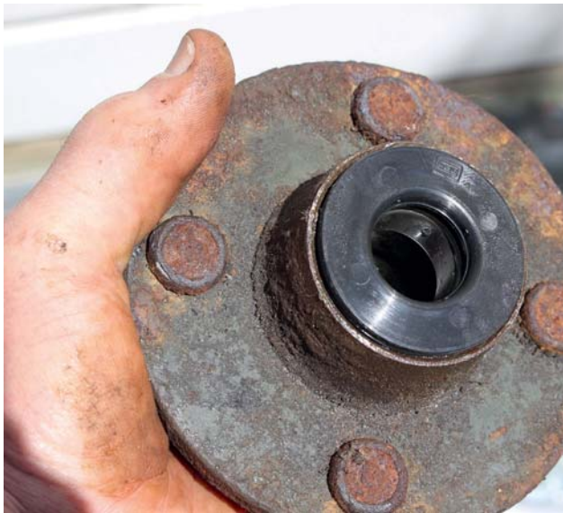
19 Sæt simreringen i inderlejet og sørg for at den er presset helt i navet.
