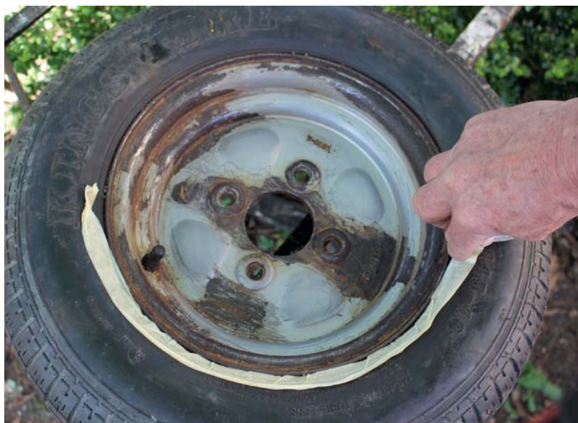
25 Sæt malertape på dækket ca. 2 mm fra stålfælgen. Både på indersiden og ydersiden af hjulet.
