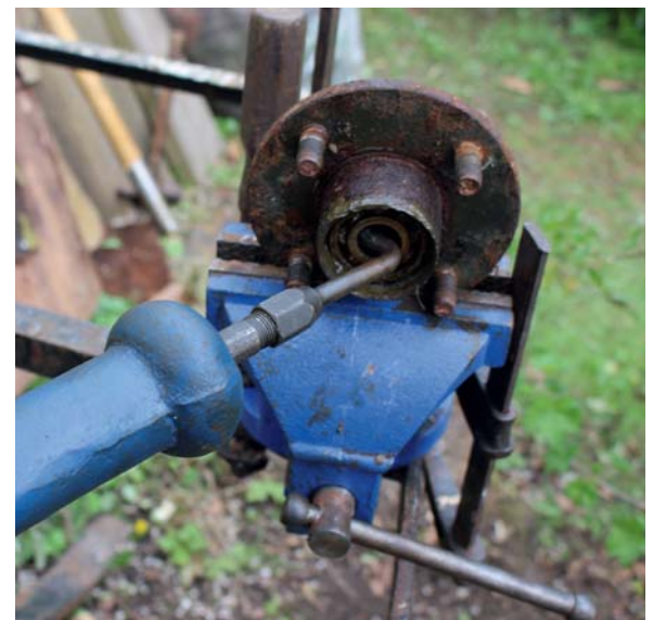
12 Sæt glidehammers smalleste gribeklo ind i lejet og slå glideren mod toppen af glidestangen.
