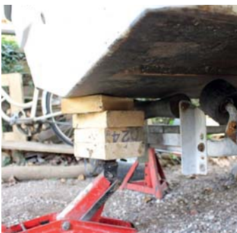
32 Aflast traileren fra båden med en donkraft, når traileren skal indstilles i rullestøtter og stævnstøtte.
