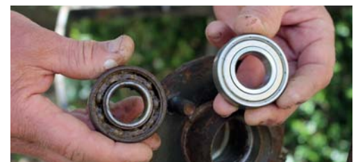
16 Kontroller at det ny leje har det samme lejenummer som det gamle leje. Nummeret står på lejeringen.
