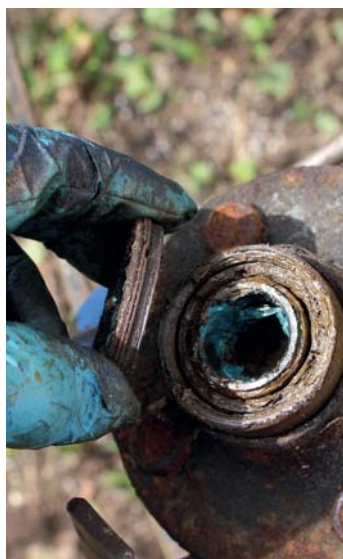
14 Tag simreringen og baglejet ud på samme måde med glidehammeren.
