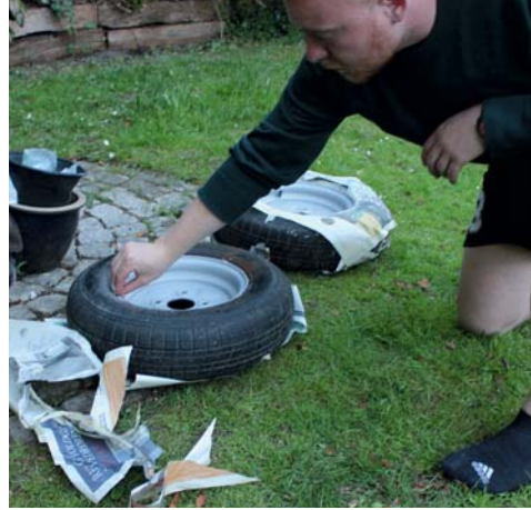
28 Fjern afdækningen og rengør bolthullerne hvis de er blevet overmalet.
