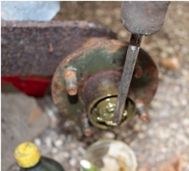
7 Vrid låsesplitten op med en skruetrækker og træk med tang mens der slås let med hammer i modsat ende af splitten.
