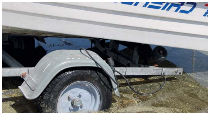
37 Demonter altid lysbroen, og kør aldrig traileren længere ud end at hjulnavet akkurat er over vandlinjen.
