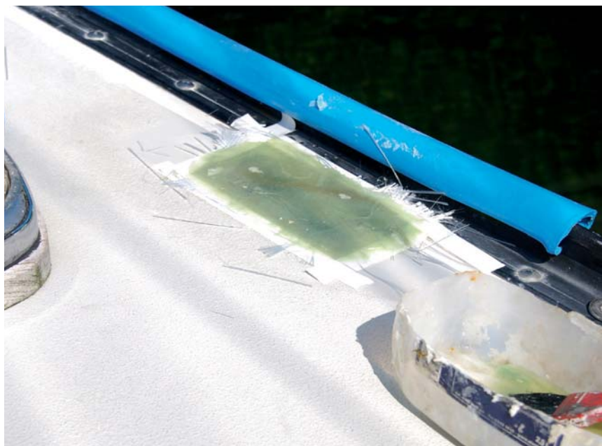
10 Læg flere lag glasvæv i den våde epoxy indtil 1 mm over dæksniveau er opnået.
