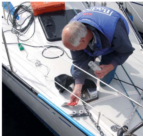
14 Gelcoat-spartel kan påføres med spartel på hele reparationen. Derefter males der med grå nuance.
