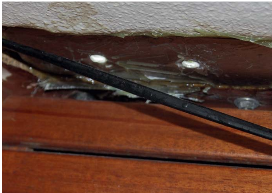
16 Inden reparationen males med dækkende gelcoat eller alkydmaling, er det en god ide at markere pladehullerne med et tyndt bor nedfra. Lyset i hullerne kan tydeligt ses gennem lamineringen.
