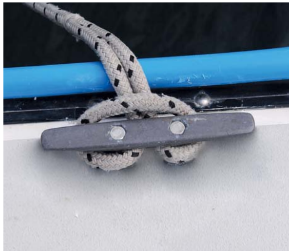
20 Reparationen skal trækprøves inden sommerturen. Start motoren og lav pæltræk agter og for. Lad båden svinge frem og tilbage i egen svingninger. Kontroller at alle forløjningsklamper holder. Hold specielt øje med eventuelle mikrorevner. Rødbedesaft er en god indikatorvæske.
