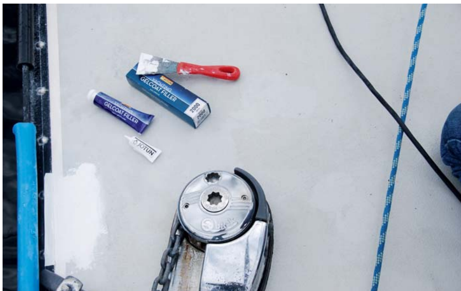
13 Den originale gelcoat-nuance kan være svær at finde. Den hvide nuance er nr. 1000. Den kan bruges som grundfarve langs skandækslisten og hele reparationen.
