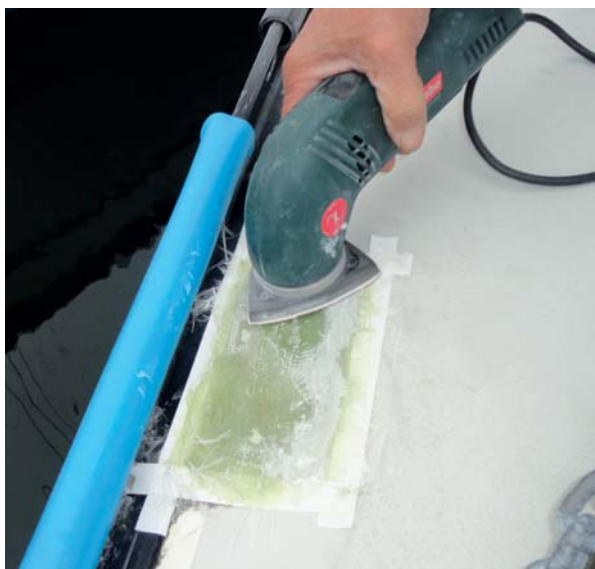
11 Deltasliberen er god til at komme ind i hjørner og langs skandækslisten. Slib så jævnt som muligt, derved undgås eventuel efterspartling.
