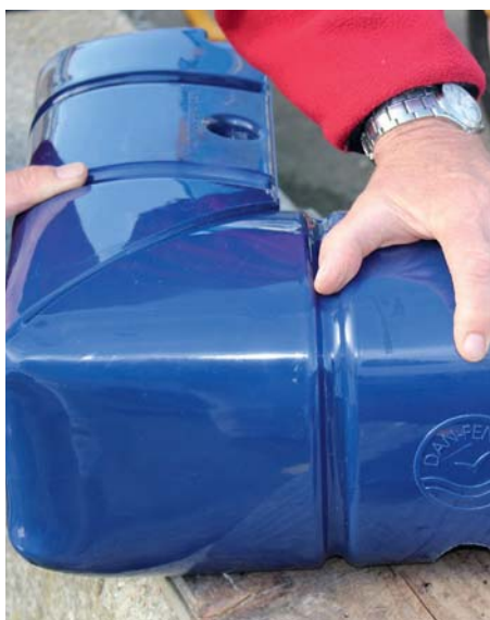
7 Kontroller når brofenderen bøjes og inden monteringen, at samlingen næsten er usynlig og i 90 grader.
