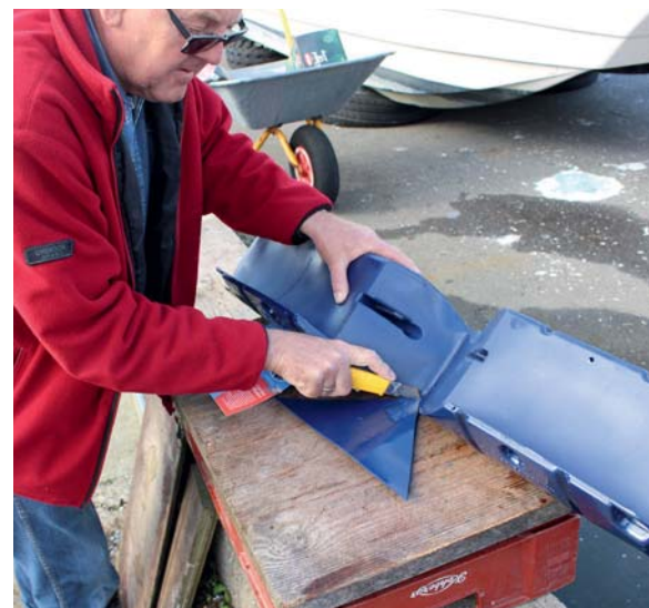
6 Skær i den markerede linje med en skarp hobbykniv. Vinklen er 90 grader og brofenderen kan efterfølgende bøjes. Ved andre vinkler skal der laves en skabelon. Overfør vinklen indvendig i udskæringsområdet.
